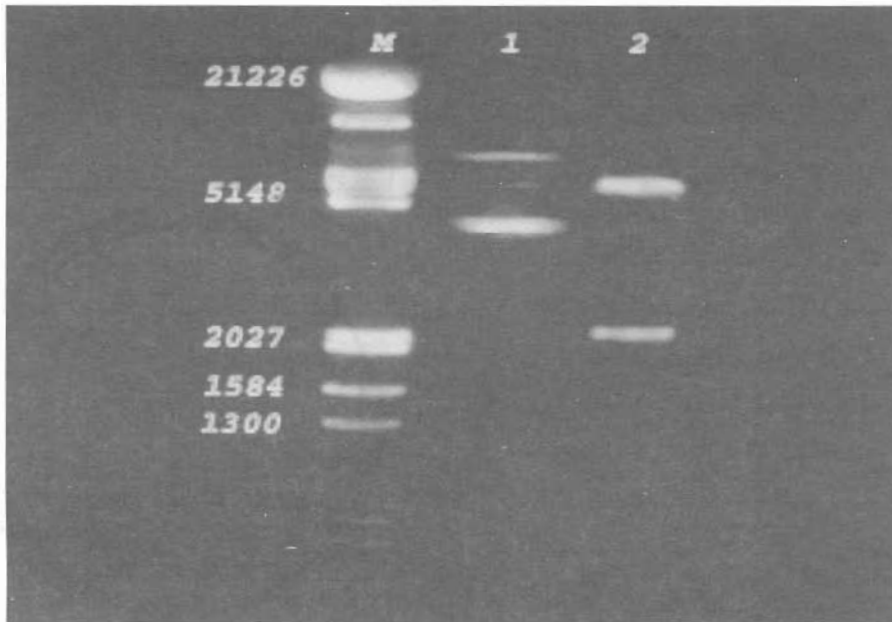
شکل ۲ الکتروفورز پلاسمید pAc-gB در آگاروز ۱٪ قبل و بعد از هضم با آنزیم BamHI. (۲) پلاسمید هضم نشده- (۳) پلاسمید هضم شده و خارج شدن قطعه ۲۸۰۰ نوکلئوتیدی gB از درون پلاسمید
