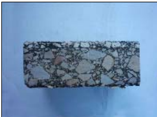
شکل ۳. مقطع اندود دولایه با محل شیار افتادگی گرانیت A
