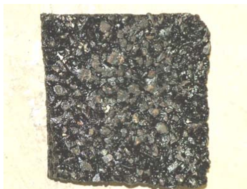
شکل ۲. نمونه آسفالت با استخوانبندی سنگدانه‌ای
