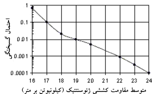
شکل ۹. احتمال گسیختگی در مقابل متوسط مقاومت کششی ژئوستتیک
