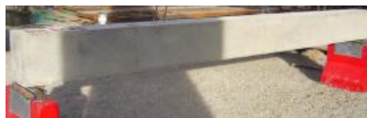
(الف) تیر بتنی ساخته شده در آزمایشگاه، تحریک شده توسط چکش ۱
