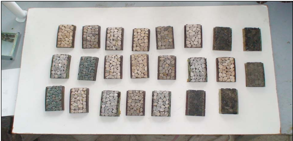
شکل ۴. نمونه‌های رزینی آماده شده برای آزمایش صیقل
