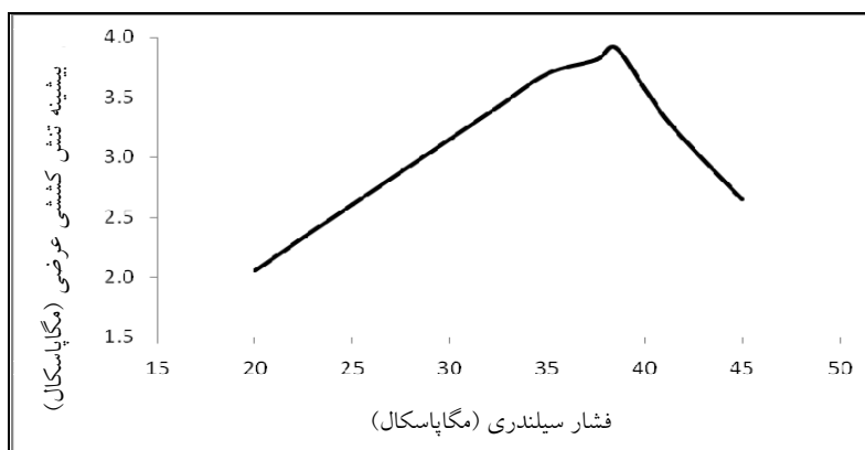
شکل ۹. تغییرات تنش کششی حداکثر اطراف سوراخ رولپلاک‌ها (حد واصل دو رولپلاک هر پابند) با افزایش فشار سیلندری
