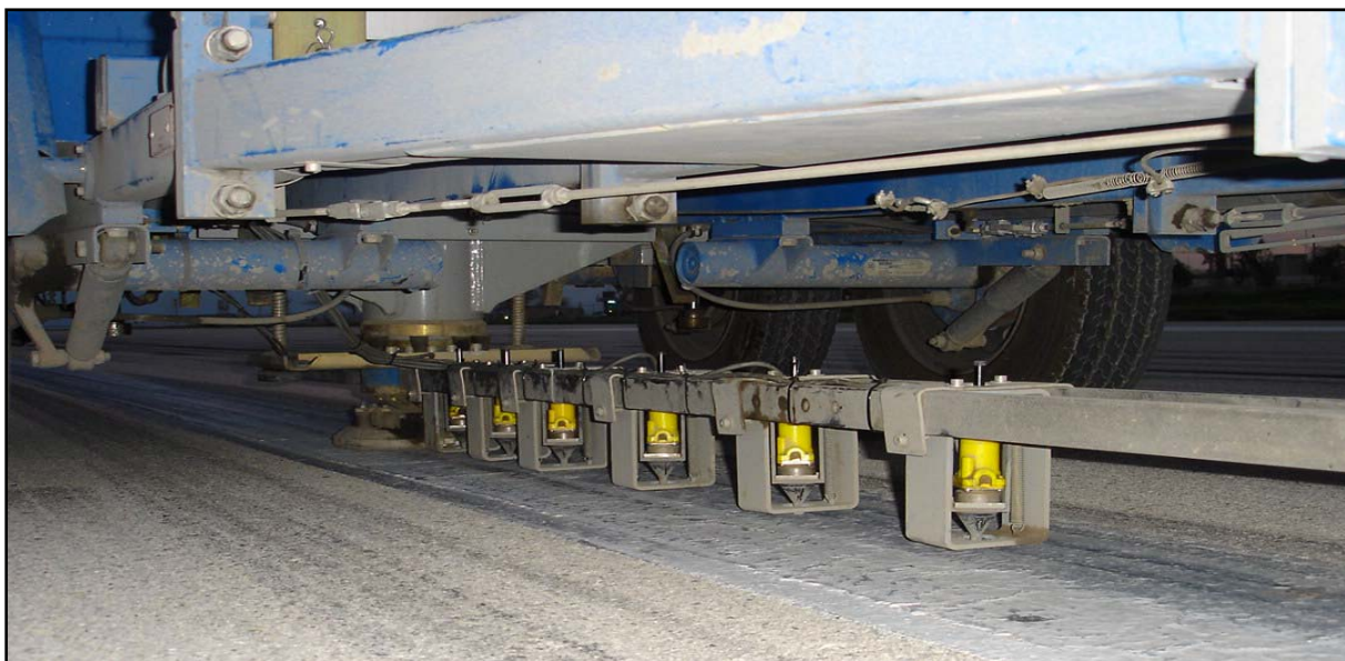
شکل ۶. محل قرارگیری حسگرهای دستگاه افت و خیزسنج ضربه‌ای
