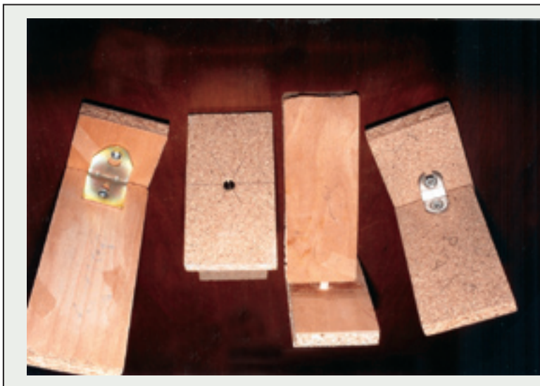
شکل ۴- نمونه‌هایی که آزمایش و بوسیله تستینگ شکسته شده‌اند - از سمت راست، نمونه‌های اول و سوم مربوط به تخته‌های بدون روکش و دو نمونه دیگر مربوط به تخته‌های روکش‌دار هستند
