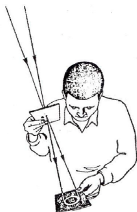
شکل ۱- روش استفاده از Pinehole Projector برای دیدن کسوف: پشت به خورشید بایستید و صفحه‌ای که یک روزنه در وسط آن قرار داد را به طرف بالا بگیرید، به طوری که نور کسوف از روزنه عبور نماید و تصویر کسوف بر روی یک صفحه دیگر ظاهر شود.
