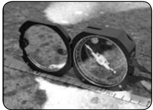
(تصویر شماره ۲) بهره‌گیری از کمپاس مدل به همراه متر جهت اندازه‌گیری شیب
