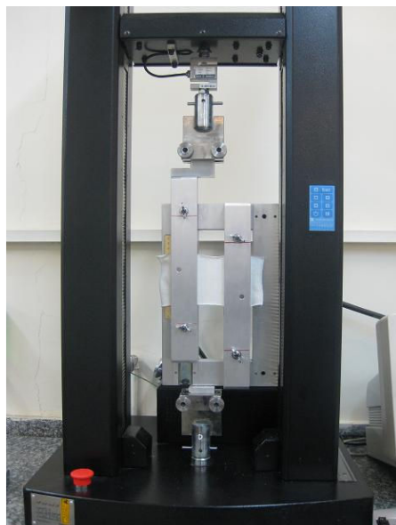
شکل ۱. تصویر دستگاه قرار داده شده روی دستگاه استحکام سنج نخ و پارچه در هنگام آزمایش
