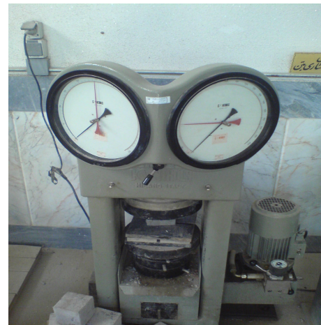
شکل ۱. نمایی از دستگاه مقاومت فشاری
