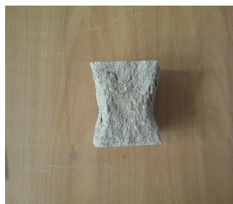
شکل ۳ . نمونه بتن شکسته شده
