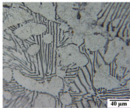
شکل ۳- ساختار یوتکتیک Al/Mg_2Si .
