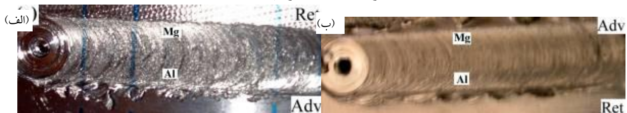
شکل 6- اتصالات بدست آمده در سرعت چرخش 571 دور در دقیقه و سرعت حرکت ابزار 21 میلیمتر در دقیقه در حالت 2
