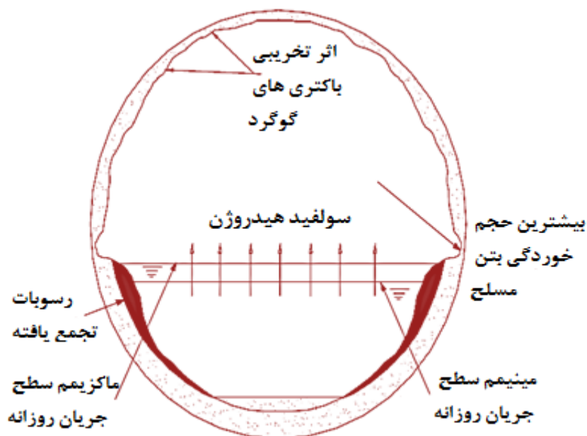
شکل 2- فعالیت باکتریایی و خوردگی تاج و قسمت‌های در تماس با مایع فاضلاب لوله فاضلاب و
