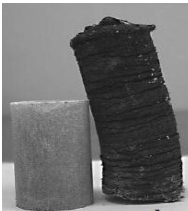
شکل 1- ایجاد اعوجاج و تخلخل در فرآورده‌های ناشی از سنتز احتراقی (سمت راست)، قطعه خام فشرده شده (سمت چپ) در اثر واکنش‌های گرمای شدید و خروج گاز و ناخالصی‌ها.
