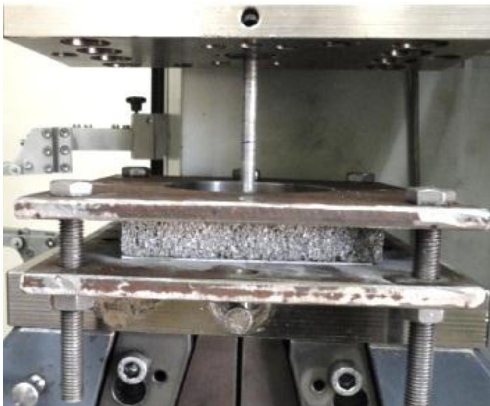
شکل 4- تصویری از نمونه حین آزمون سوراخ‌کاری.
