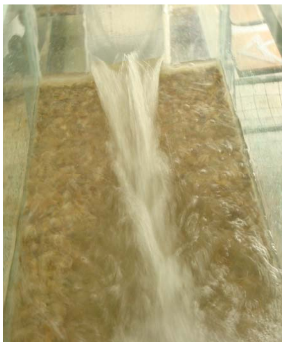
شکل ۴- فوران ورودی به حوضچه ی استغراق.
