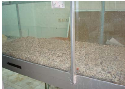
شکل ۳- حوضچه ی استغراق ساخته شده در داخل نهر پایدار
