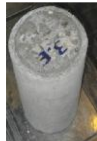
شکل ۱۴: هسته بتنی دورپیچی شده با غلاف SIFCON.
