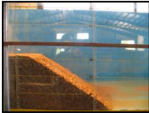
شکل ۱۰: تصویر پیشروی زبانه رسوبی در فلوم (دید از سمت جداره شیشه‌ای).
