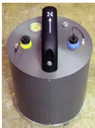
شکل ۶: سرعت سنج CMG_6TD و چگونگی نصب آن روی عرشه پل.
