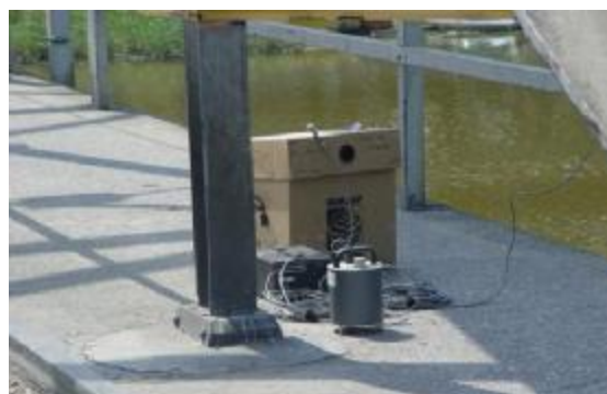
شکل ۶: سرعت سنج CMG_6TD و چگونگی نصب آن روی عرشه پل.
