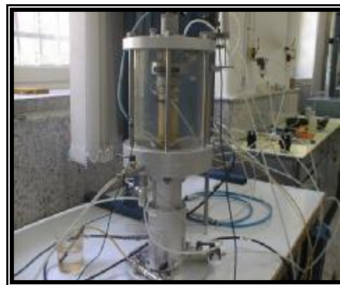
شکل ۴: دستگاه سه‌محوری مسیر تنش بیشاپ-وسلی.
