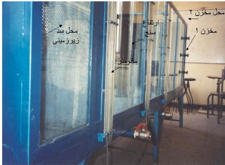
شکل ۱- مدل فیزیکی سد زیرزمینی ساخته شده
