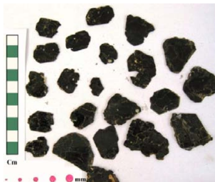
شکل ۴: میکاهای محدوده "پرام سرا" که از نظر اندازه کوچکتر از میکاهای محدوده یاعلی گوابر (شکل ۳) می باشند
