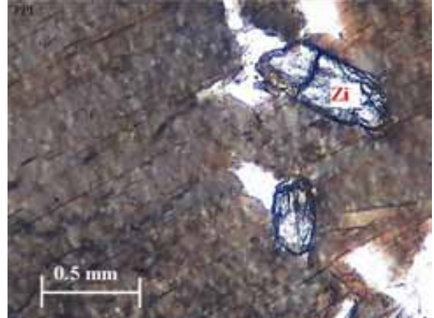
تصویر ۱۱- کانی زیرکن (Zircon) در گرانیت بن‌دونو. این کانی دارای برجستگی قوی و چند رنگی شدید در نور پلاریزه می‌باشد و بیشتر به صورت ادخال در بیوتیت‌های منطقه دیده می‌شود (نور طبیعی = PPL، نور پلاریزه = XPL).
