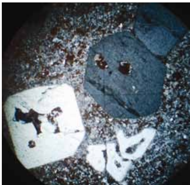
تصویر ۶- نمونه 9- CH- S: بافت پورفیریتیک، کوارتزهای خلیجی در زمینه کریپتوکریستالین دگرسان شده به اکسیدهای آهن، در ریوداسیت، بزرگنمایی ۴، XPL، ۱۰
