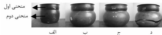
شکل ۴ قطعات تولید شده در آزمایشهای با فشارهای (الف) ۵۵ بار (ب) ۱۱۵ بار (ج) ۱۳۵ بار (د) ۱۵۵ بار
