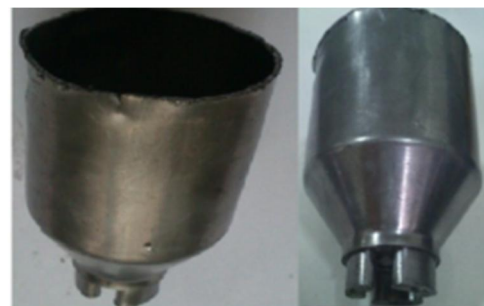
شکل 5 لوله تولید شده از فرایند جدید اکستروژن لوله
