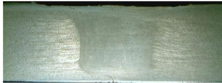
شکل 7 مقطع جوش برای ابزار با شانه 26 میلی‌متر
