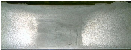
شکل 6 مقطع جوش برای ابزار با شانه 20 میلی‌متر
