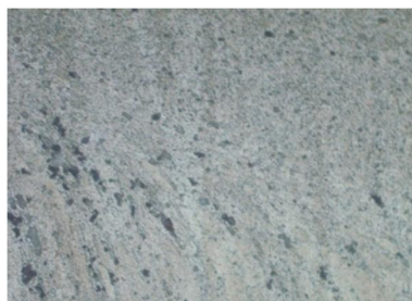
شکل 10 بزرگنمایی 400 برابر از ناحیه متأثر از حرارت و کار مکانیکی
