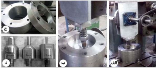
شکل 2 نمایی از فرایند کار تجربی، الف) ابزار ضربه زننده، ب) کلمپ ورق و نمونه فرم یافته، ج) سیستم کلمپ، د) قطره‌های مختلف پنچ.
