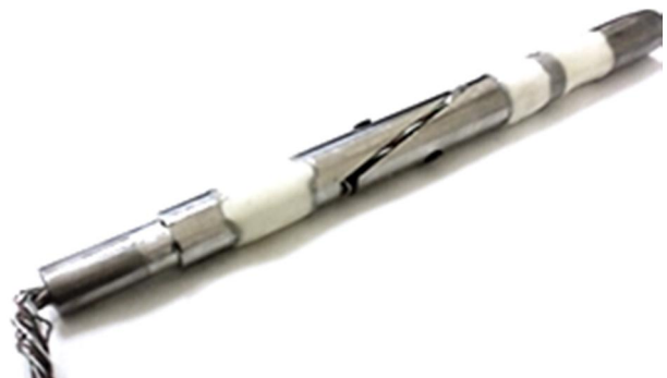
شکل 9 بالانس شش مؤلفه‌ی نیرو گشتاور ساخته شده
