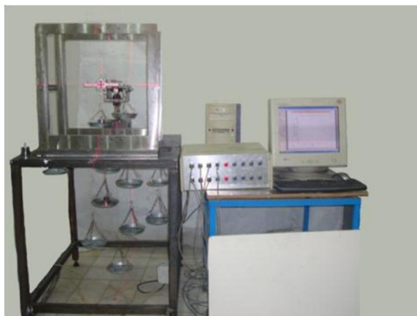
شکل 14 سیستم کالیبراسیون بالانس نیرو گشتاور
