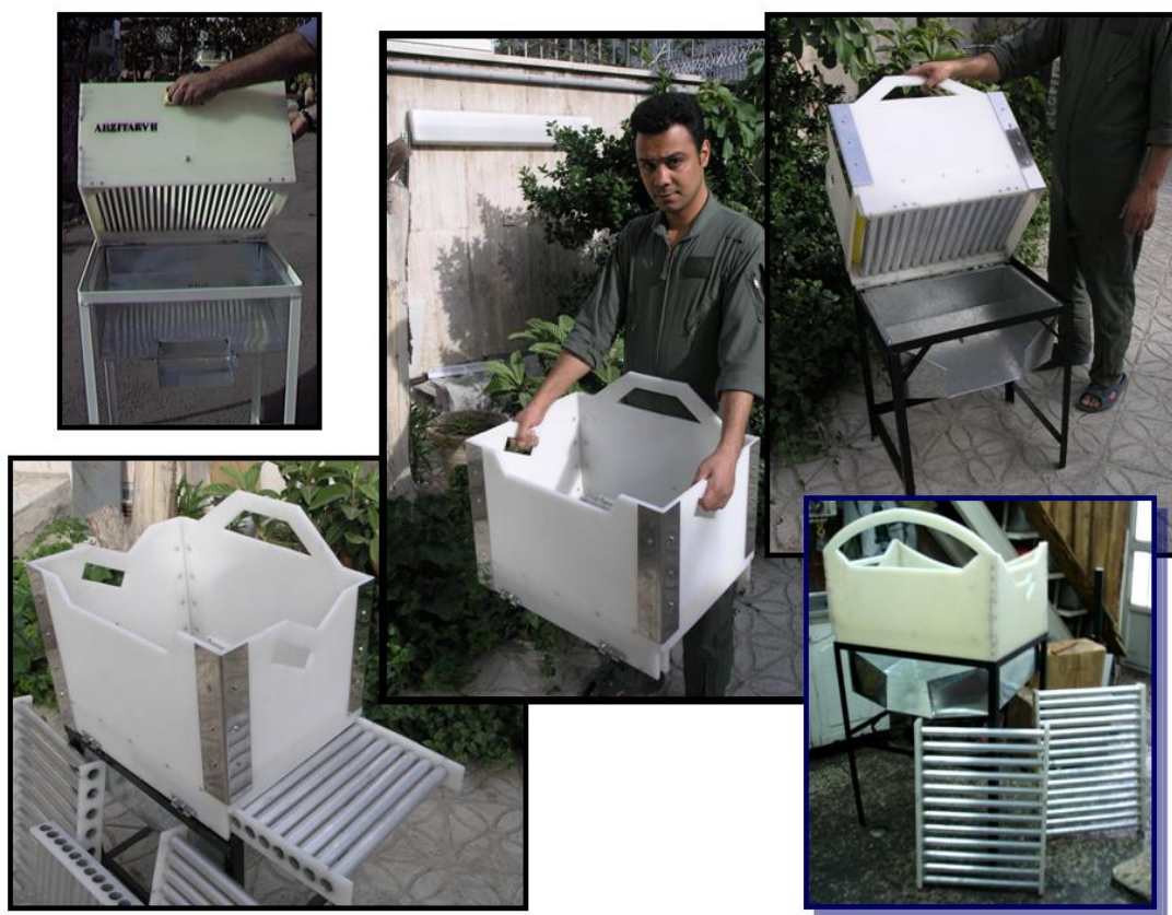
شکل ۴: بالا، راست: دستگاه رقم بند ساخته شده با پلی اتیلن و اتصال نبشی استیل در کناره ها، در حالت استفاده با میز. وسط: حالت بدون میز با ارگونومی مناسب بدن کاربر. بالا چپ: رقم بند ساخته شده با چوب به همراه میز. پائین چپ: شانه های رقم بند و نحوه کار گذاشتن آن
