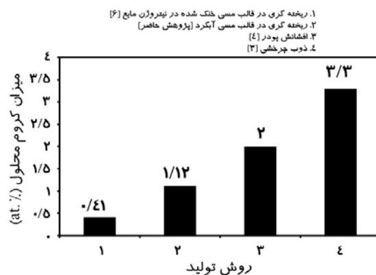
شکل (۵): تأثیر روش‌های تولید آلیاژ مس- کروم در میزان حلالیت کروم.
