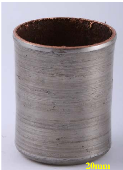
شکل (۱۴): قطعه دو لایه تولید شده، با نسبت اسپینینگ ۲.۵
