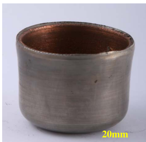
شکل (۱۲): قطعه دولایه تولید شده با نسبت اسپینینگ ۲/۲، مسیر حرکتی ابزار از نوع اینولوت
