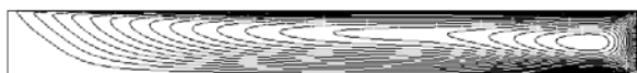
شکل (۱۱): کانتور تابع جریان برای Ri=0.1 و مدل اغتشاش Standard k - \epsilon
