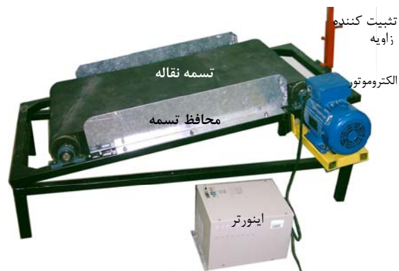
شکل (۴): شکل کلی دستگاه نوع تسمه نقاله ای
