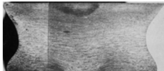
شکل (۱) نمونه ای از ایجاد عیب دم ماهی در حلقه در فرایند نورد حلقوی [۱].
