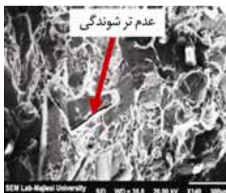
شکل (۶) عدم ترشوندگی مناسب ذرات توسط آلومینیم در سطح شکست.
