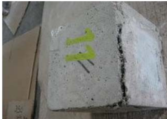
شکل ۴. شکست بتن با استحکام بالا حاوی الیاف
