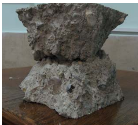
شکل ۳. شکست بتن با استحکام بالا فاقد الیاف
