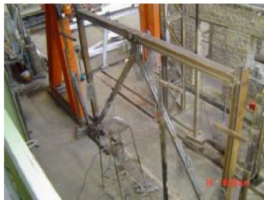
شکل ۴: نحوه استقرار نمونه های آزمایش و اعمال بار جانبی به آنها.
