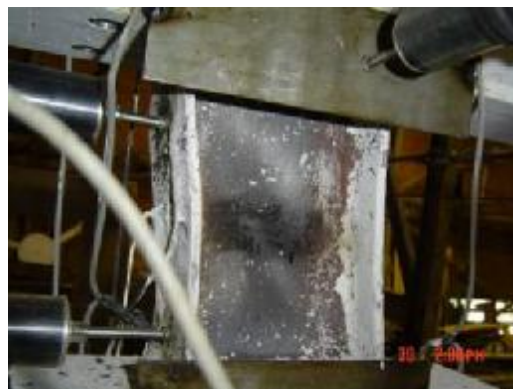
شکل ۱۲: کمانش جان تیر پیوند قائم نمونه سوم در تغییرشکل های بزرگ
