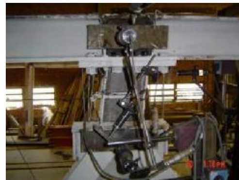
شکل ۸: ریختن کامل پوشش آهکی در چشمه‌های تیر پیوند قائم نمونه دوم به عنوان مثال، و متوازی الاضلاع شدن شکل تیر پیوند قائم در اثر تغییر شکل‌های برشی غیر ارتجاعی.
