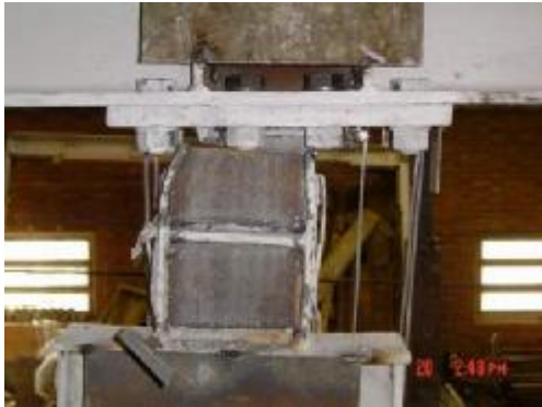
شکل ۹: بریدن کامل مقطع تیر پیوند قائم نمونه دوم و توقف آزمایش.
