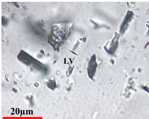
شکل ۱۷: انکلوزیون دو فازی اولیه با شکل کشیده در نمونه MC-6
