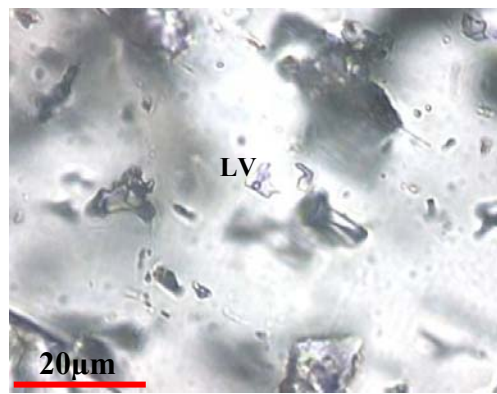
شکل ۱۶: انکلوزیون دو فازی اولیه (با نسبت حجمی L > V ) و با شکل نامنظم در نمونه MC-6
