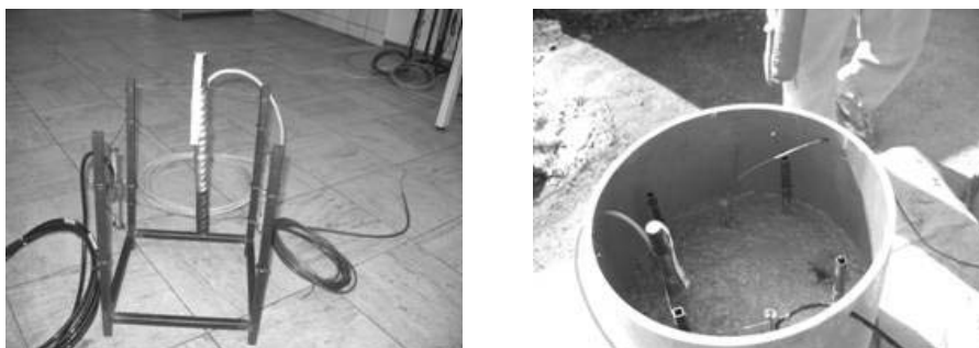
شکل ۴: نحوه قرارگیری ابزار در نمونه بتنی
