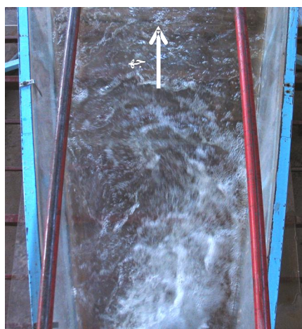
شکل ۶- پدیده جدا شدگی برای q = 9^\circ ، I_s = 54.6 و Fr_1 = 4.8 (الف)، Fr_1 = 8.7 (ب)، S = 0.35
