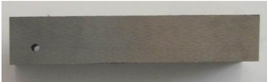
شکل ۵. قطعه اول با ۱ بازتابنده در نیمه پایینی
