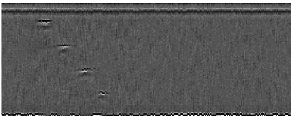
شکل ۱۰. تصویر روبش B حاصل از قطعه سوم با ۴ بازتابنده
