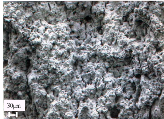
شکل ۱۰. ریز ترکهای مشاهده شده در نواحی مرکزی سطح شکست، مربوط به فولاد D.AE با ۰/۳ درصد کربن در تنش متوسط ۳۰۰ MPa.
