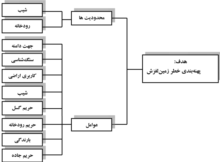
شکل ۴- درخت‌واره تحلیل چندمعیاره مکانی پهنه‌بندی خطر زمین لغزش حوضه آبخیز شلمانرود.
