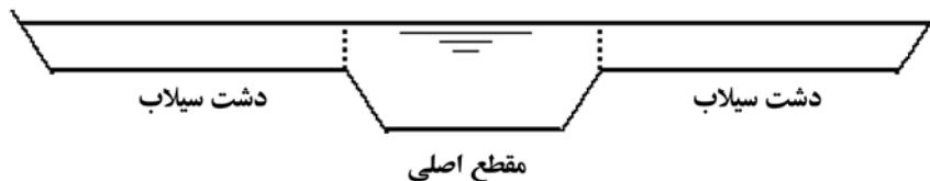
شکل ۱- مقطع مرکب و تجزیه آن به مقطع اصلی و دشت‌های سیلابی.
