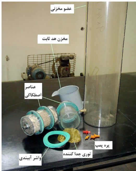
شکل ۴ عناصر مدل آنالوگ مایع
