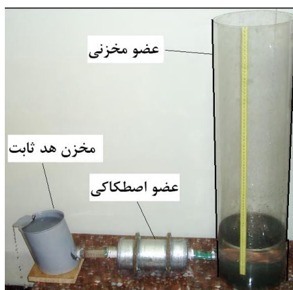
شکل ۵ یک مدار مدل آنالوگ مایع
