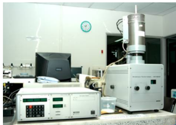
شکل ۱- دستگاه STA جهت اندازه گیری ویژگی های حرارتی مواد مختلف.
